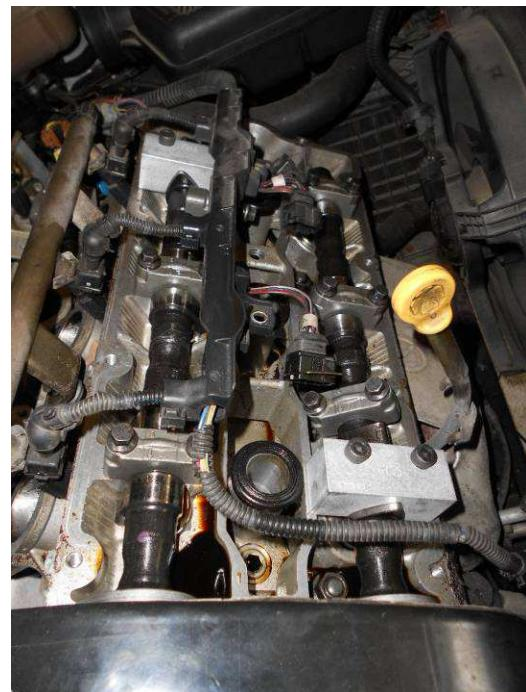
Démonter les vis (1a) et enlever le tendeur mobile de la courroie de distribution (1b).
