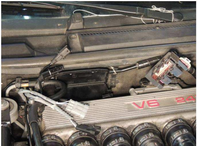
Dévisser les vis (1a) et déposer le boîtier à connexions (1b).
