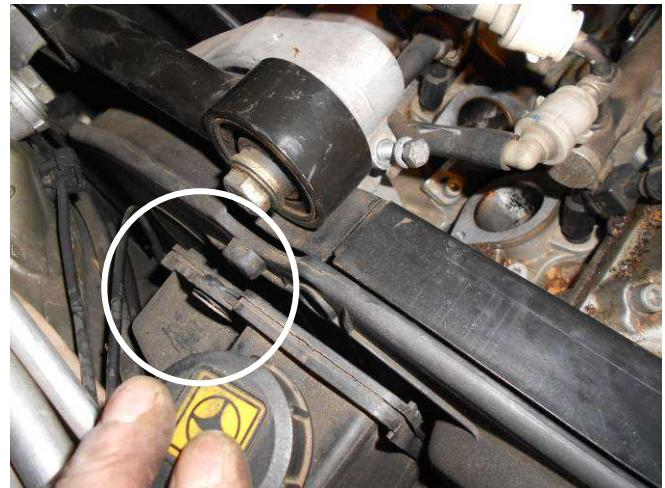
Dévisser les 3 vis (1a) et enlever le couvercle de protection supérieur de commande distribution (1b).
