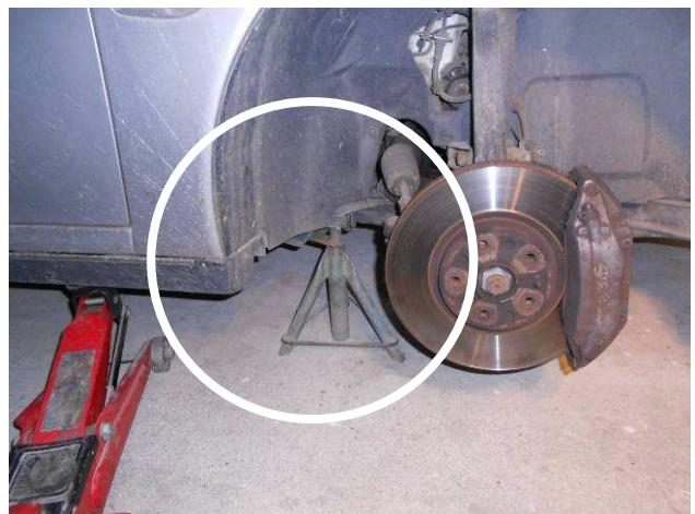
Dévisser les vis de fixation du demi-passage de roue AV à la coque.
