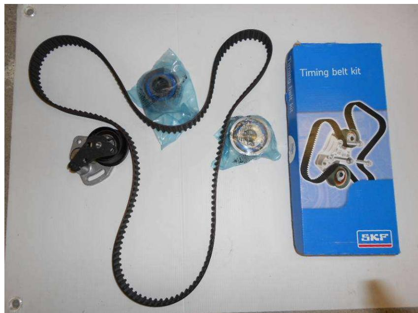
Remonter les tendeurs fixes de la courroie de distribution **serrage 1.8 à 2 daNm**
