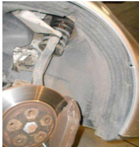
Dévisser les vis de fixation du demi-passage de roue AR à la coque.
